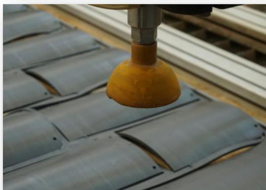
• **WATERJET** è un sistema automatizzato, che esegue lavorazioni di precisione decimale, mediante l'utilizzo di un sottile getto d'acqua.
